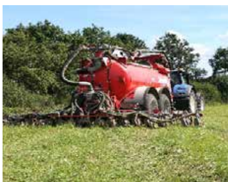
Épandage des boues par les tonnes à lisier pour enfouissement sur les prairies ou par pendillards sur les terrains nus
